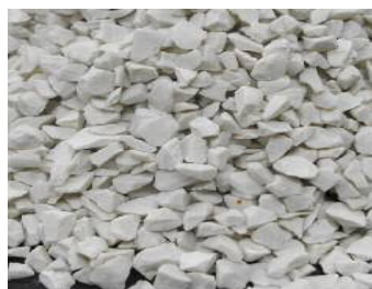
セラサンドHW-A1 (温度抑制効果 12.3℃)
