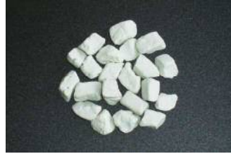
HW-N(白) 6号 造粒型 明色舗装用硬質骨材
