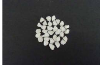
HC-A 1粒~C粒 遮熱型硬質骨材
