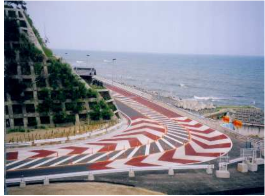
セラグリップ (樹脂系すべり止め舗装)
